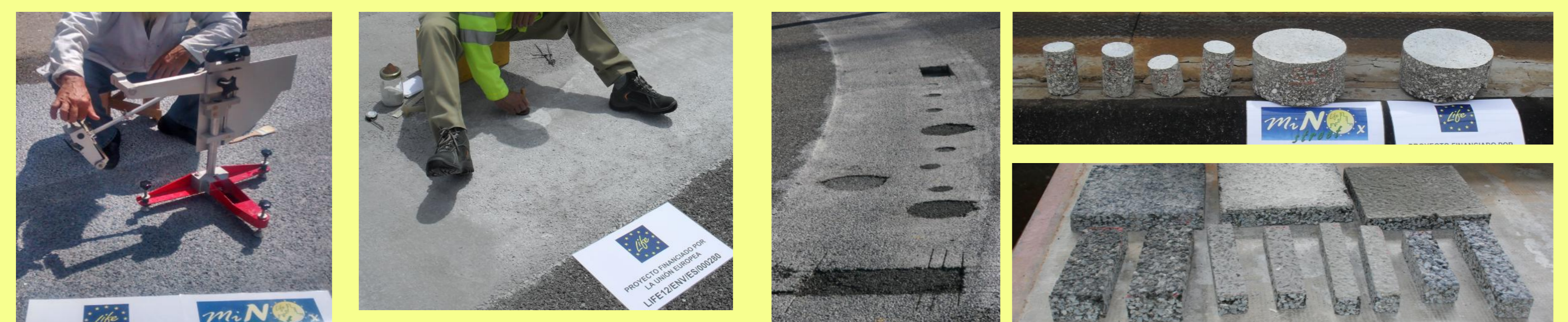
Extracción y corte de testigos y catas para ensayos de laboratorio:
