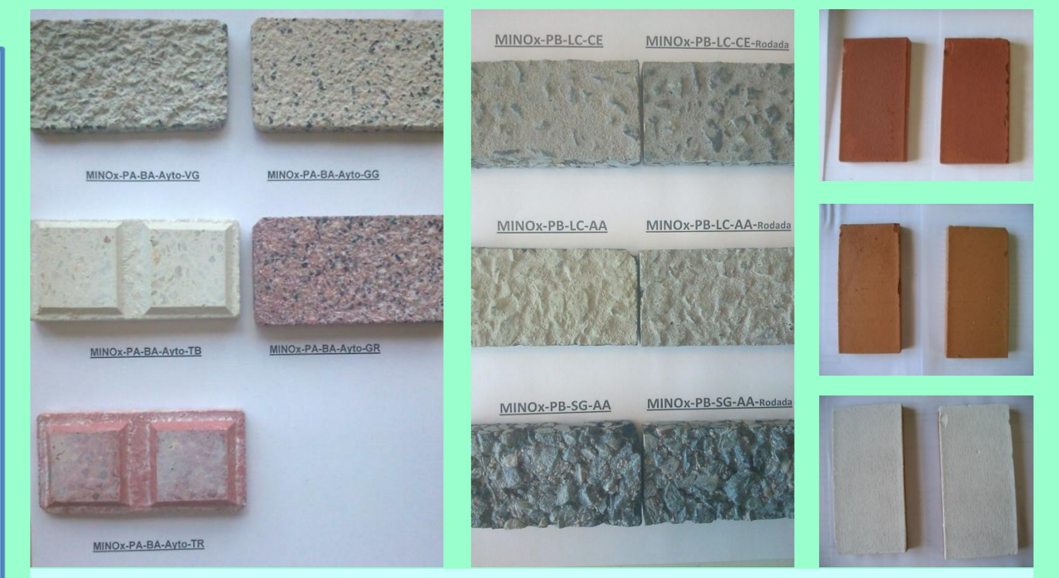
Muestras de productos prefabricados de hormigón, mezclas bituminosas y pinturas ensayados bajo ISO 22197-1 por "FOTOAIR-Tratamiento Fotocatalítico de Contaminantes en Aire" del CIEMAT
