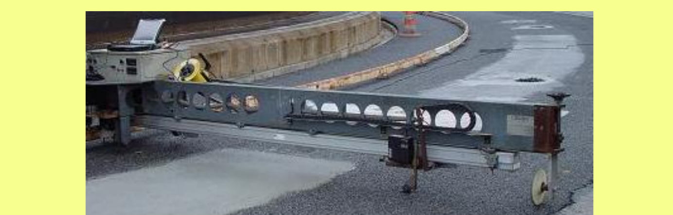
Medida del coeficiente e resistencia al deslizamiento con el Péndulo del TRRL, ensayo del círculo de arena para la medida de la profundidad media de textura y ensayo para evaluar la regularidad transversal de las secciones
